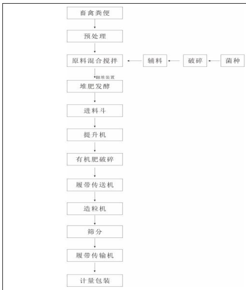
图4.1-6 有机肥生产工艺流程图
